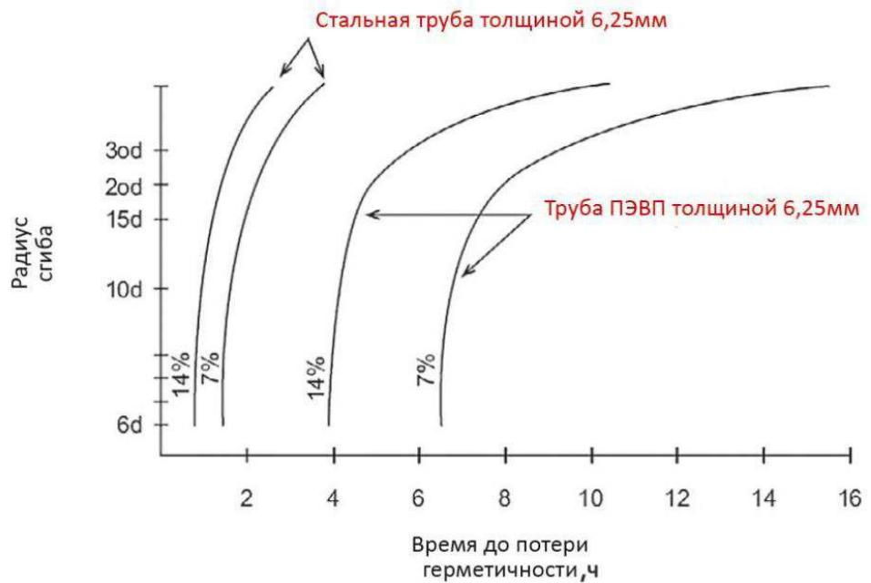
Рисунок 6 – Данные по абразивному износу для стальных и ПЭВП труб
