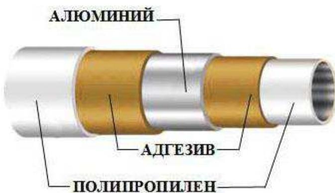
Рисунок 4 – ПП труба с алюминиевым армирующим слоем
