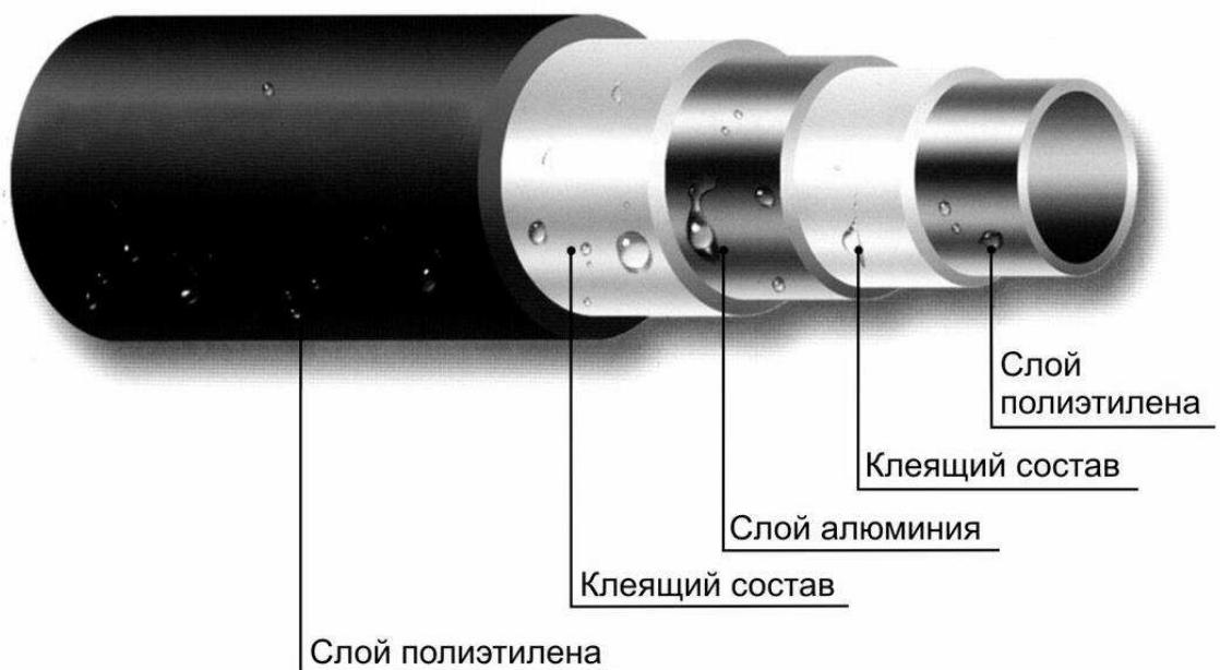
Рисунок 2 – Труба из ПЭ с алюминиевым армирующим слоем
