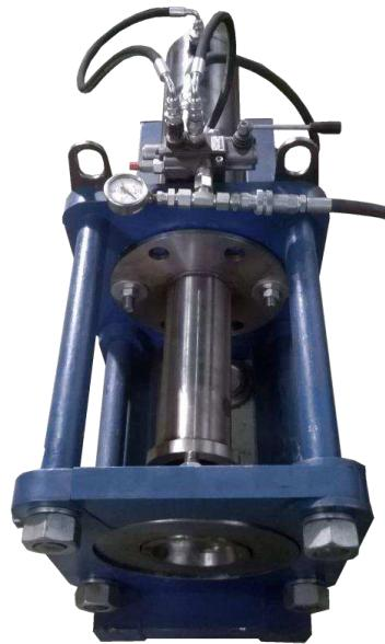
Рисунок 15 – Гидравлический пресс для установки фитингов трубных фланцевых и фитингов трубных под приварку.
