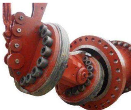
Рисунок 1 – Запорное устройство STOPPLE®-TRAIN
