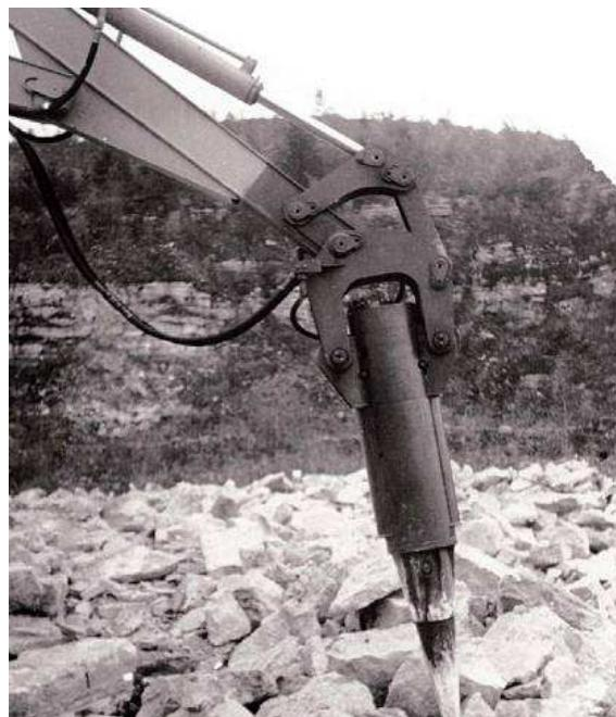
Рисунок 2.1 – Экспериментальный гидромолот ВНИИ Стройдормаш
