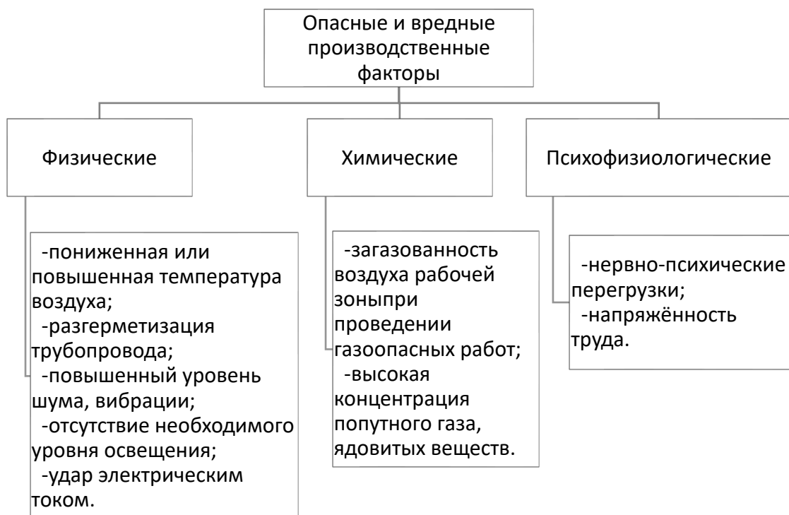
Рисунок 28 – Опасные и вредные производственные факторы, воздействующие на трубопроводчика линейного при выполнении работ по предотвращению и ликвидации последствий перемерзания коллектора, согласно ГОСТ 12.0.003[43]
