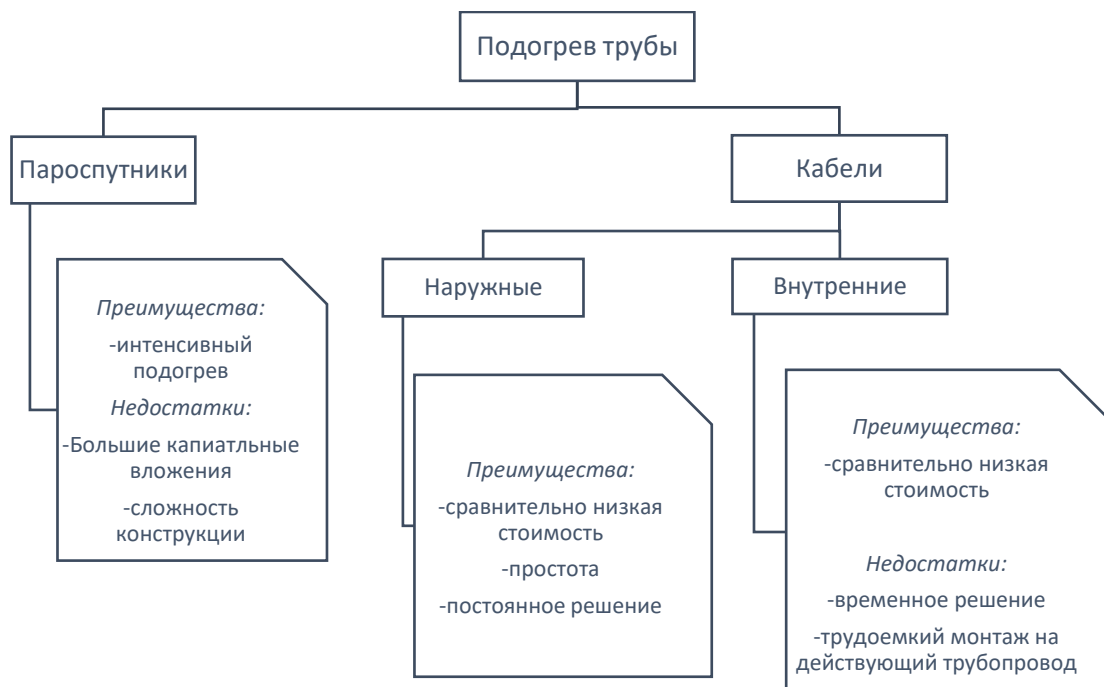
Рисунок 22 – Сравнительный анализ способов подогрева трубопровода
