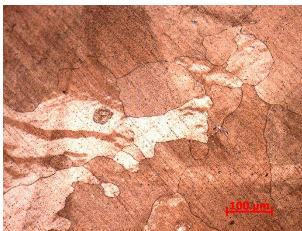
Рисунок 3.4 – микроструктура образца дисперсно-упрочненного сплава 2 , модифицированного кадмием (0,1%) и микролегированного РЗМ (0,1%) (x200)
