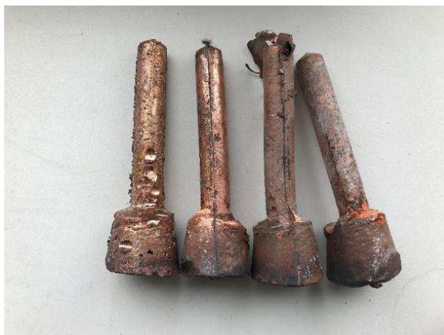
Рисунок 2.3 – полученные образцы после литья в кокиле
