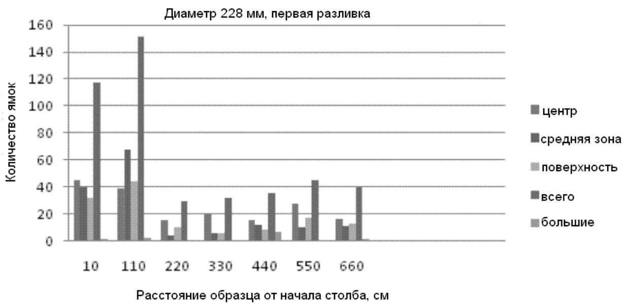
Рисунок 2.5 – Распределение включений по длине столба из вторичного алюминия диаметром 228 мм – первая разливка
