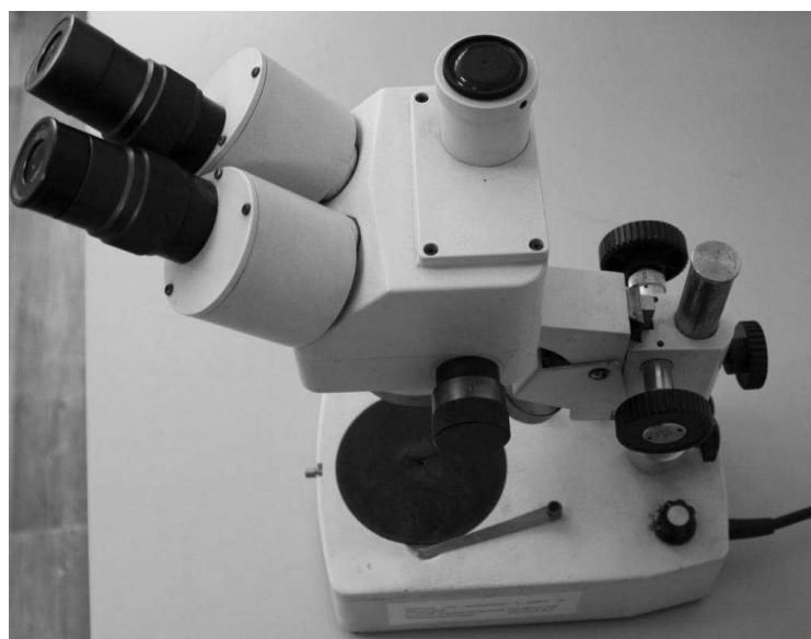
Рисунок 3.2 – Стереоскопический микроскоп МС -2
