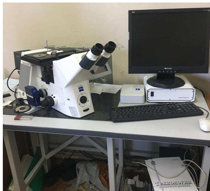
Рисунок 8 – Микроскоп *Axio Observer Z1m*
