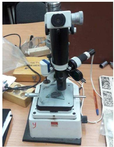
Рисунок 12 – Микротвердомер ПМТ–3
