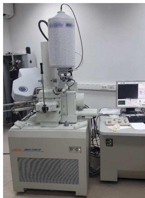
Рисунок 11 – Сканирующий электронный микроскоп (СЭМ) *JEOL JSM 7001F*
