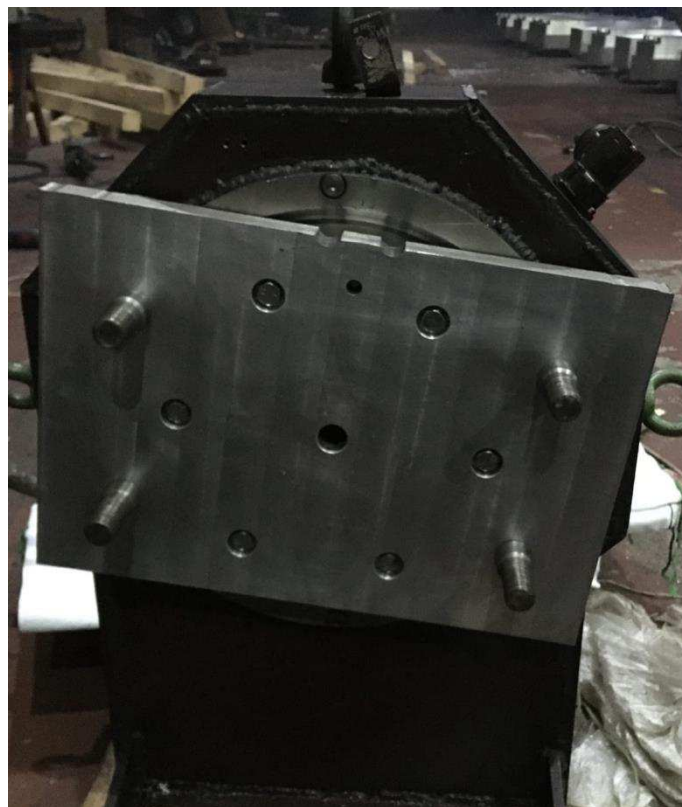
Рисунок 9 – Плита для посадки редуктора
