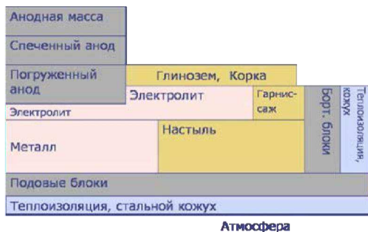
Рисунок 10 – Схематичное представление электролизера для тепловых расчетов
