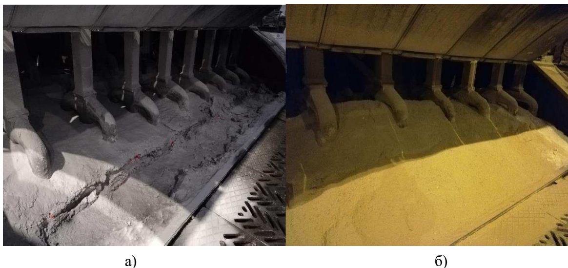
Рисунок 5 – Состояние анодного массива, с различной толщиной укрывного материала
