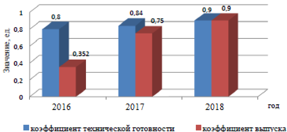
Рисунок 11 – Изменение величины коэффициента технической готовности и коэффициента выпуска автомобилей на линию
