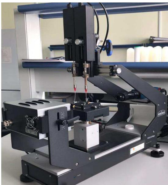
Рисунок – 4 Прибор для исследования поверхностных характеристик
