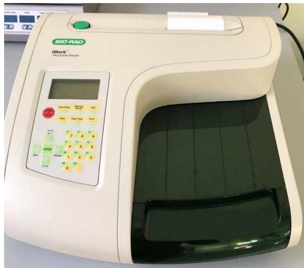
Рисунок 6 – прибор для измерения оптической плотности «Bio-RAD»
