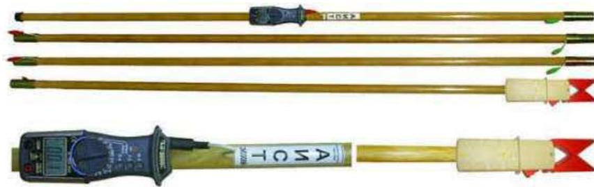
Рисунок 3.3- Автономный индикатор сетевого тока “АИСТ” ЭИ3008М
