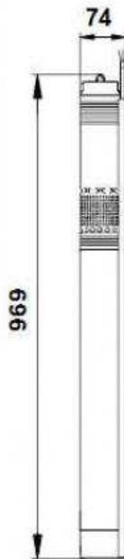
Рисунок 2.3 - Конструкция погружного насоса Grundfos типа SQE
