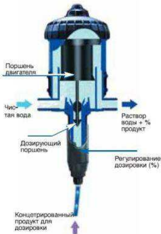
Рисунок 1.9 – Строение дозатора D25RE10 VF
