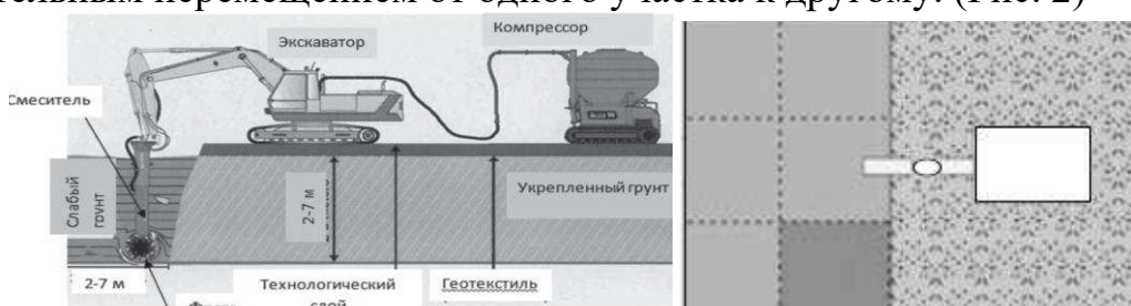
Рис. 2 – Метод блочной стабилизации грунта
