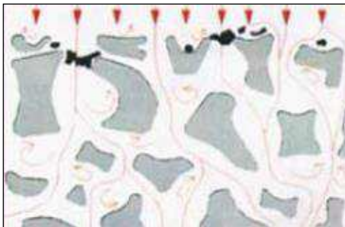
Рисунок 12 – Оседание включений на поверхности фильтра
