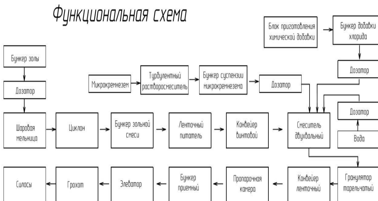
Рисунок 12– Функциональная схема безобжигового зольного гравия
