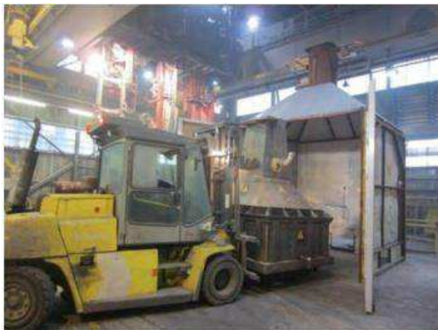
Рисунок 11 – Установка укрытого огарка под вытяжной зонт
