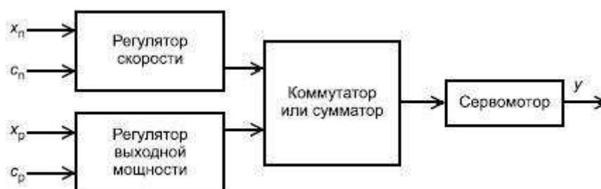
Рисунок 1.2 - Системы параллельного управления регуляторами скорости и выходной мощности
