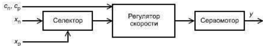
Рисунок 1.7 - Управление мощностью через регулятор скорости
