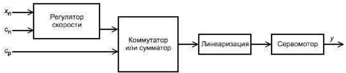
Рисунок 1.3 - Система параллельного регулирования скорости и мощности
