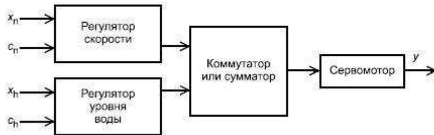
Рисунок 1.4 - Система параллельного регулирования скорости и уровня воды
