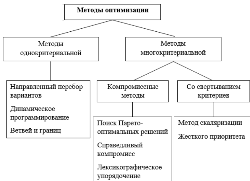
Рисунок 2.1 - Схема с разделением по числу критериев и видам методов оптимизации.
