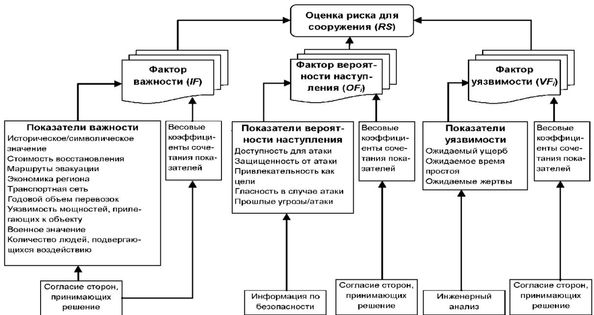
Рисунок 2.2 – Риск АНВ и его последствий на критичных мостах
