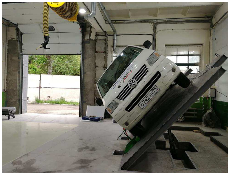
Рисунок 4.3 – Транспортное средство на опрокидывающей платформе в положении, в котором наблюдается отрыв обоих колес одной стороны от опорной поверхности (вид спереди)
