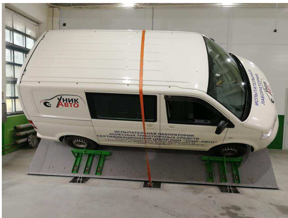
Рисунок 4.4 – Транспортное средство на опрокидывающей платформе в положении, в котором наблюдается отрыв обоих колес одной стороны от опорной поверхности (вид слева)
