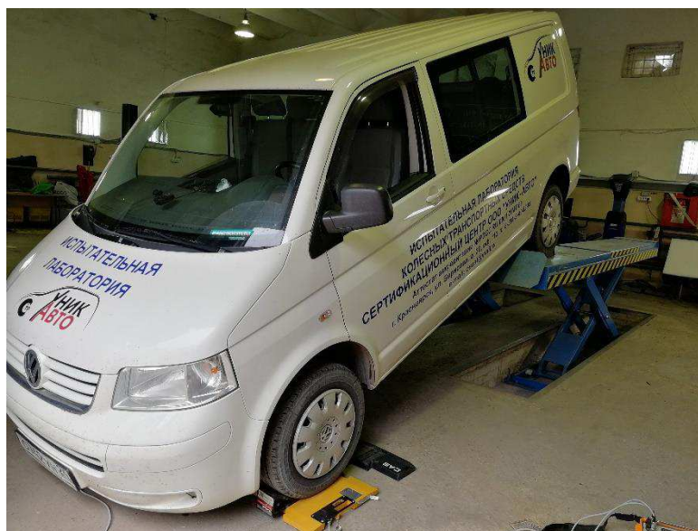
Рисунок 4.6 – Определение координаты высоты центра масс АТС путем перераспределения нагрузок между осями продольном наклоне транспортного средства
