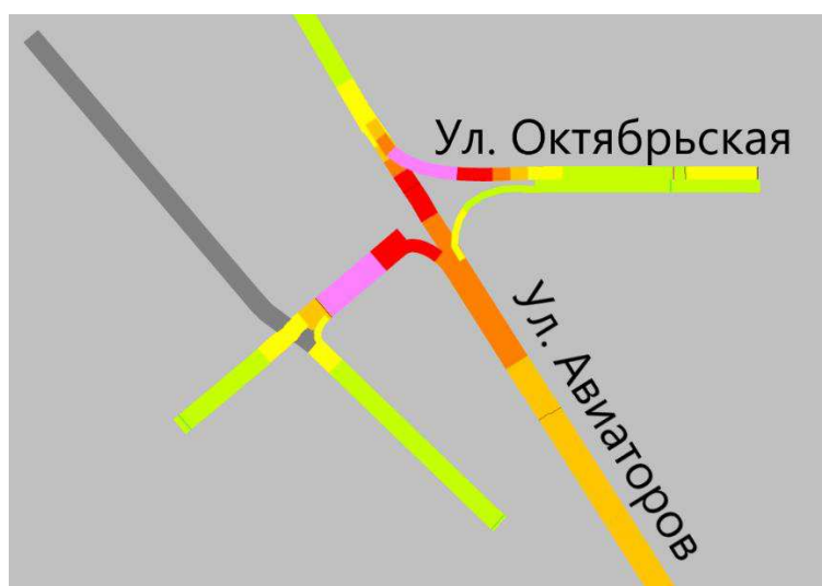
Рисунок 2.17 – Цветовое отображение транспортных потоков при существующей ОДД на участках УДС ул. Авиаторов – ул. Октябрьская
