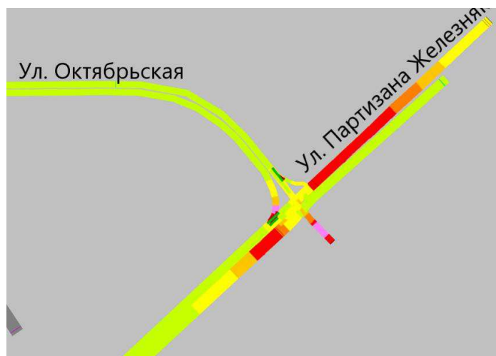
Рисунок 2.14 – Цветовое отображение транспортных потоков при существующей ОДД на участках УДС ул. Партизана Железняка – ул. Октябрьская
