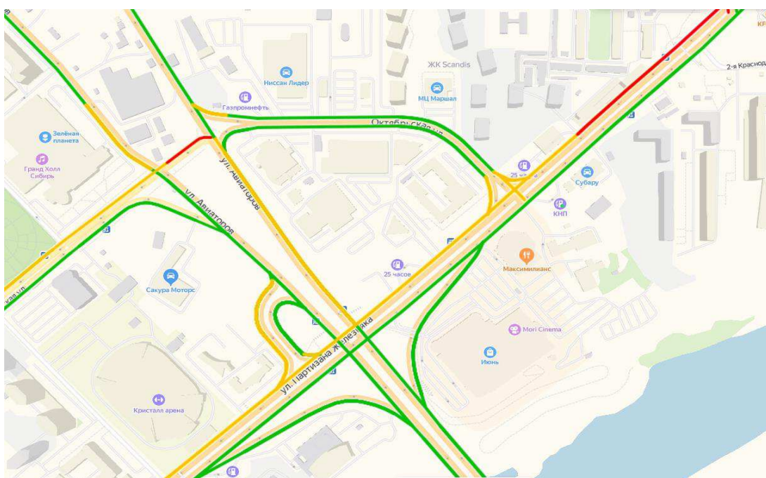
Рисунок 1.12 – Состояние транспортных потоков на пересечении ул. Партизана Железняка — ул. Октябрьская, ул. Авиаторов — ул. Октябрьская по данным сервиса «Яндекс – пробки» в утренний «час – пик» 19.03.2020.
