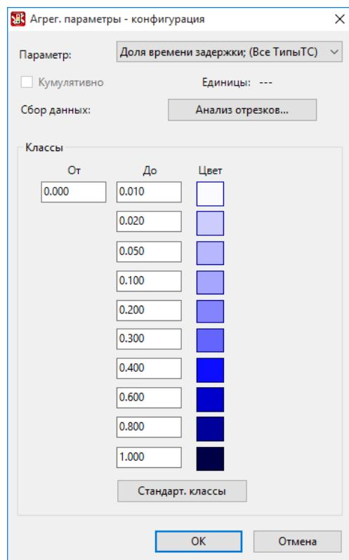
Рисунок 2.29 – Цветовая гамма оценки состояния транспортных потоков (доля задержки транспортных средств)
