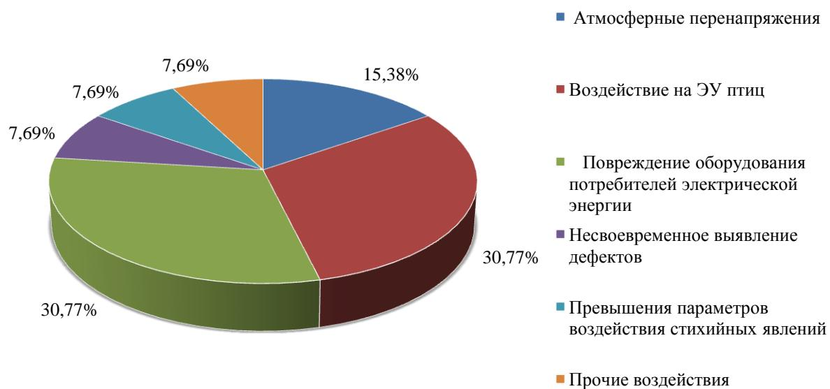
Рисунок 2.1 – Структура аварийных отключений ПС «Вершино-Биджа» в 2017 году
