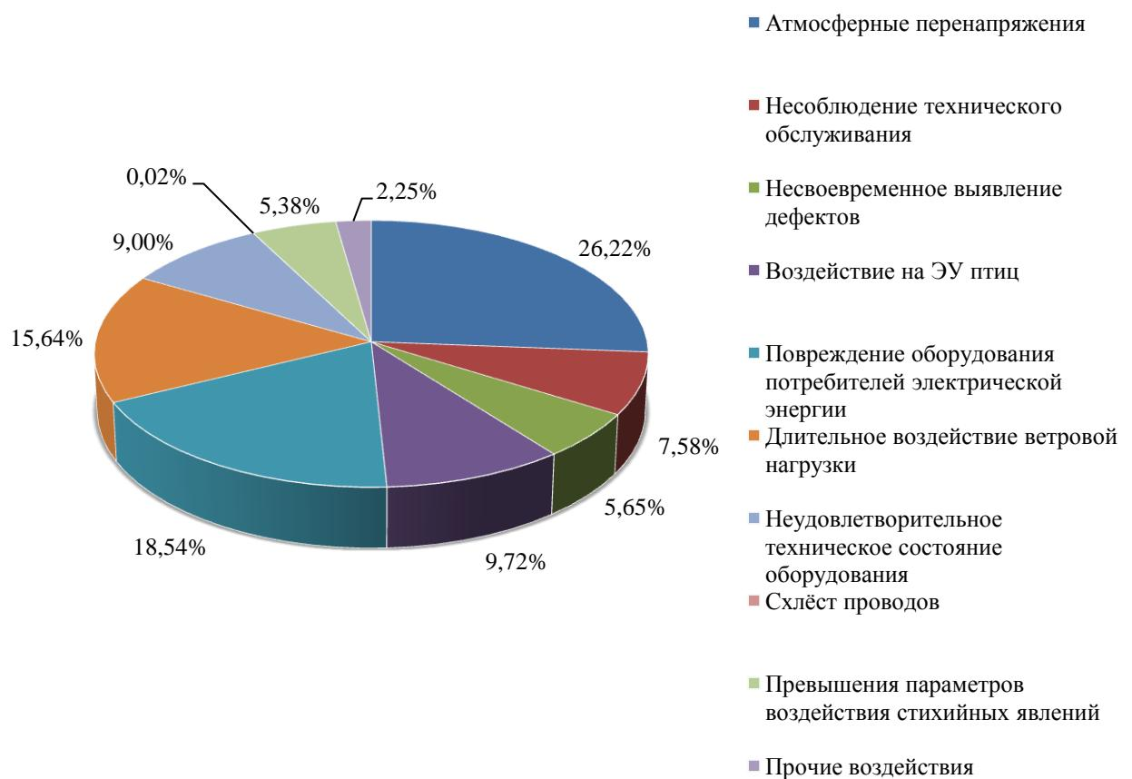
Рисунок 2.11 – Структура аварийных отключений подстанций «Вершино-Биджа» и «Московская» по продолжительности
