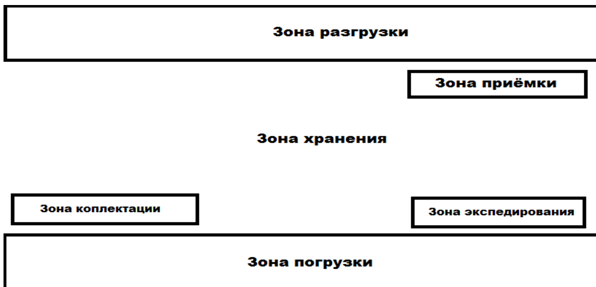
Рисунок 2 – Схема транспортно-складского комплекса
