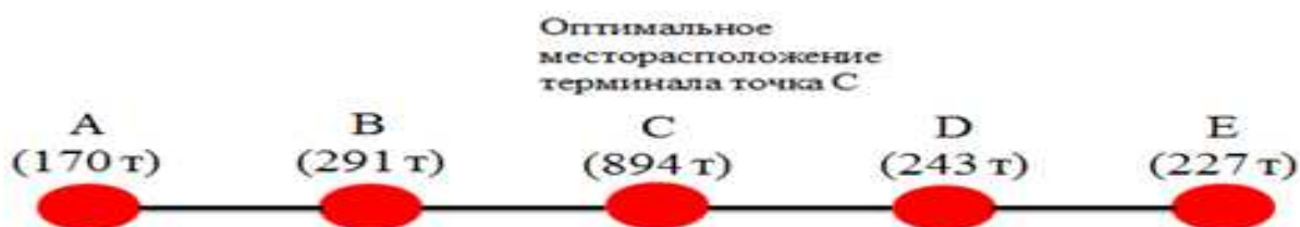
Рисунок 2.2 – Определение оптимального места расположения терминального комплекса на участке обслуживания методом пробной точки
