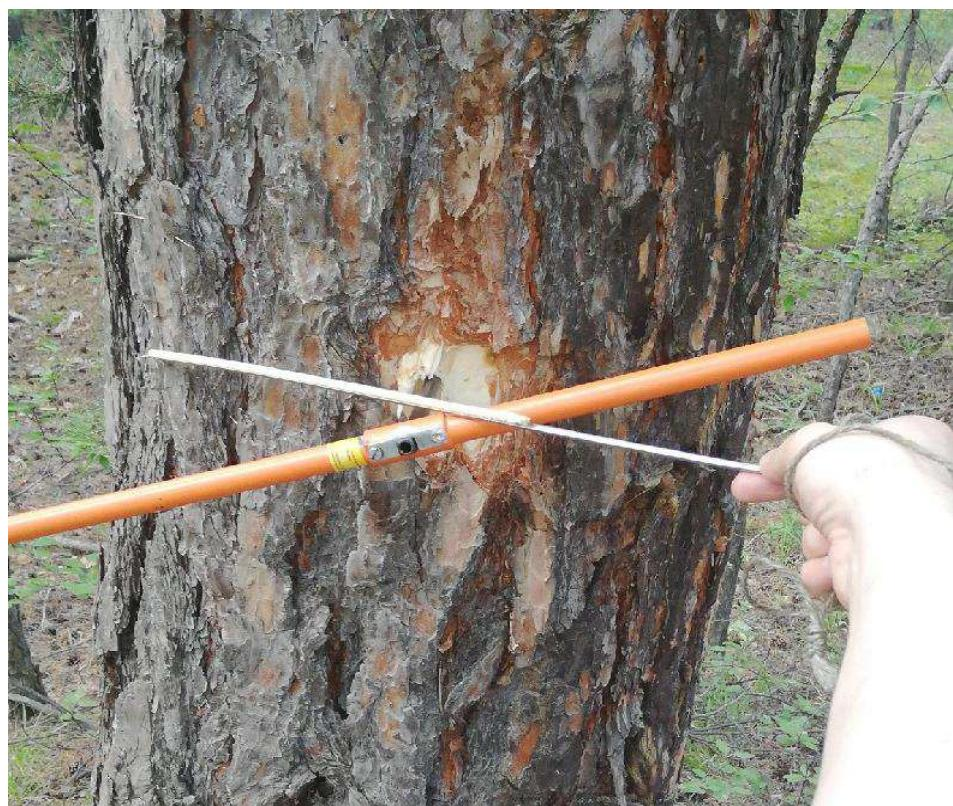
Рисунок 9 – Свежесобранный керн на экстракторе (фото автора)
