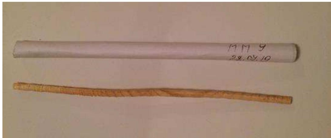
Рисунок 10 – Керн и конверт, с промаркованной датой сбора, и кодом тестового полигона (фото автора)
