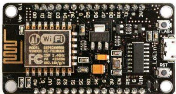
Рисунок 6 – Микроконтроллерная система ESP8266
