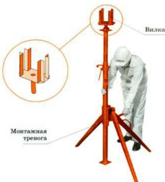
Рисунок 4.1 – Закрепление опорной стойки
