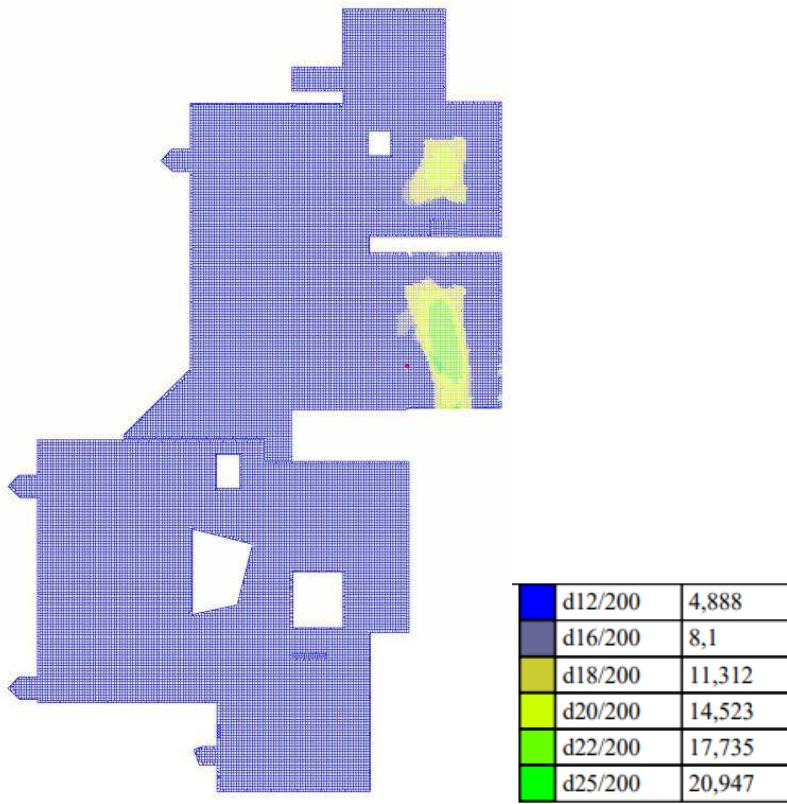
Рисунок 2.1 – Схема нижнего армирования по оси X
