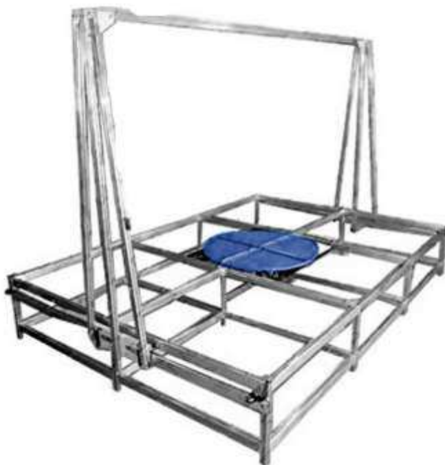
Рис. 1.6 Станок с ЧПУ для фигурной резки ФРП-01
