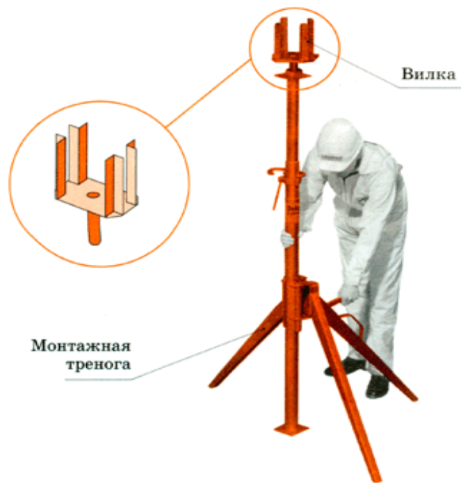
Рисунок 4.2 – Закрепление опорной стойки
