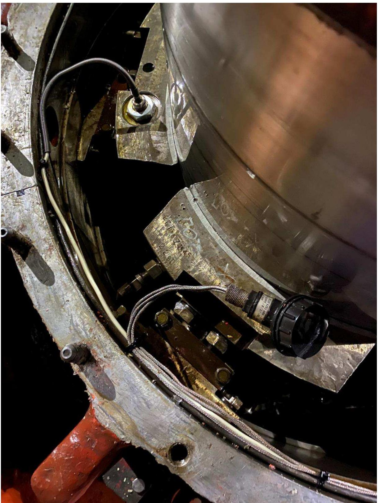
Рисунок 7 – Расположение ТСП и термобаллона ТКП 160 на сегментах турбинного подшипника
