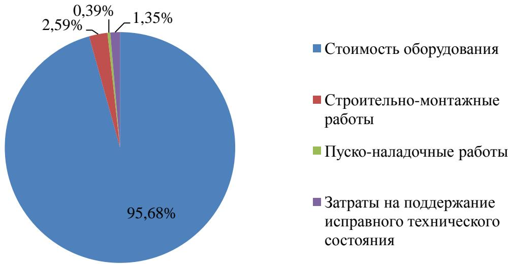
Рисунок 19 – Диаграмма капитальных затрат и затрат на поддержание исправного технического состояния электроцилиндра в течение всего жизненного цикла (сорока лет)
