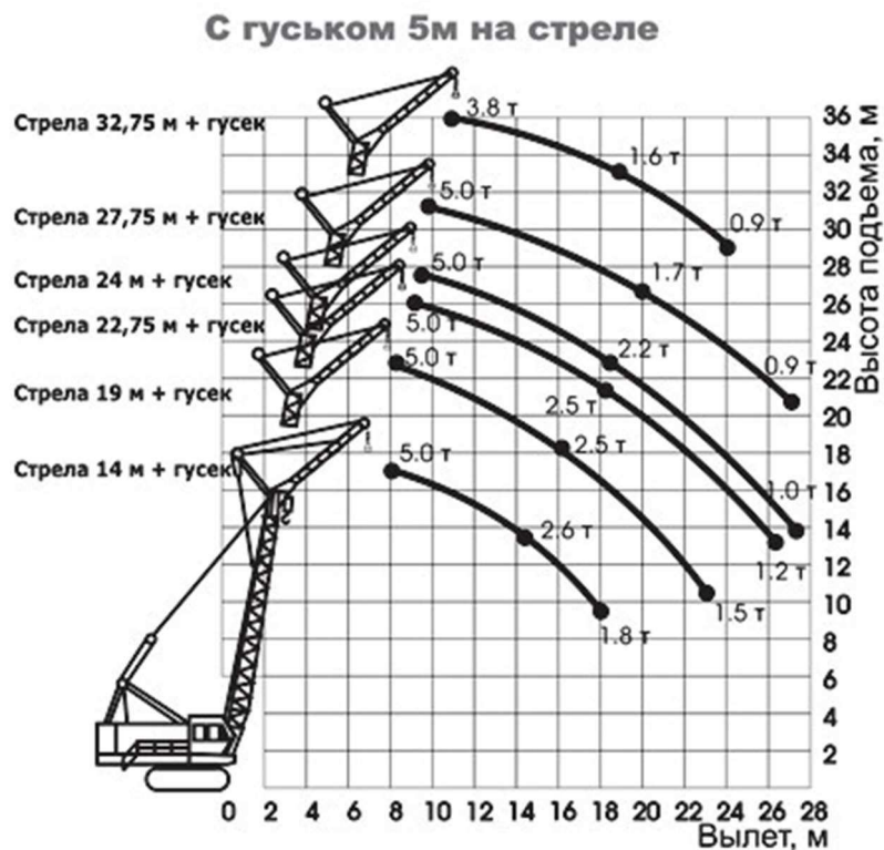
Рисунок 5.14 – Технические характеристики крана ДЭК 251
