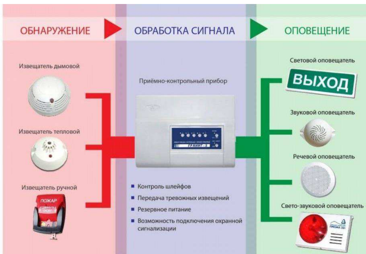
Рис. 9.9 – схема работы системы автоматической пожарной сигнализации
