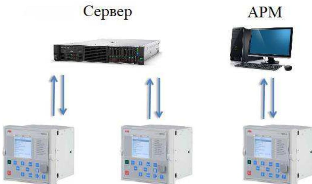
Рисунок 9.3 – Связь терминалов с верхним уровнем
