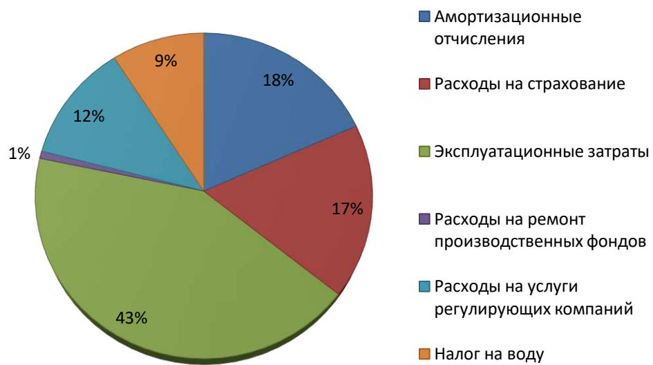
Рисунок 8.1 – Структура текущих затрат по гидроузлу, %
