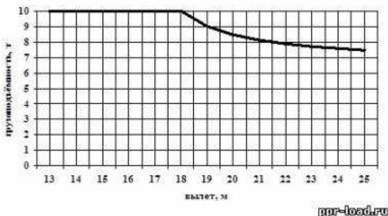
Рисунок 3 – График грузоподъемности крана КБ-405.1А
