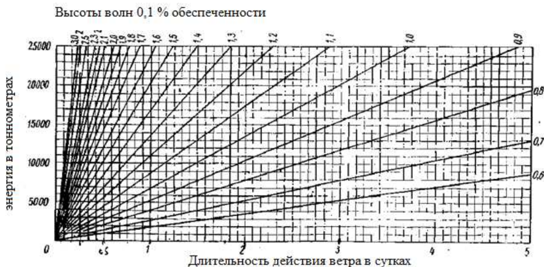
Рисунок 8 – Номограмма А.П. Браславского для определения энергии волнения по длительности действия ветра и высоте волны 0,1% обеспеченности с горизонтальной шкалой на 5 суток [24]
