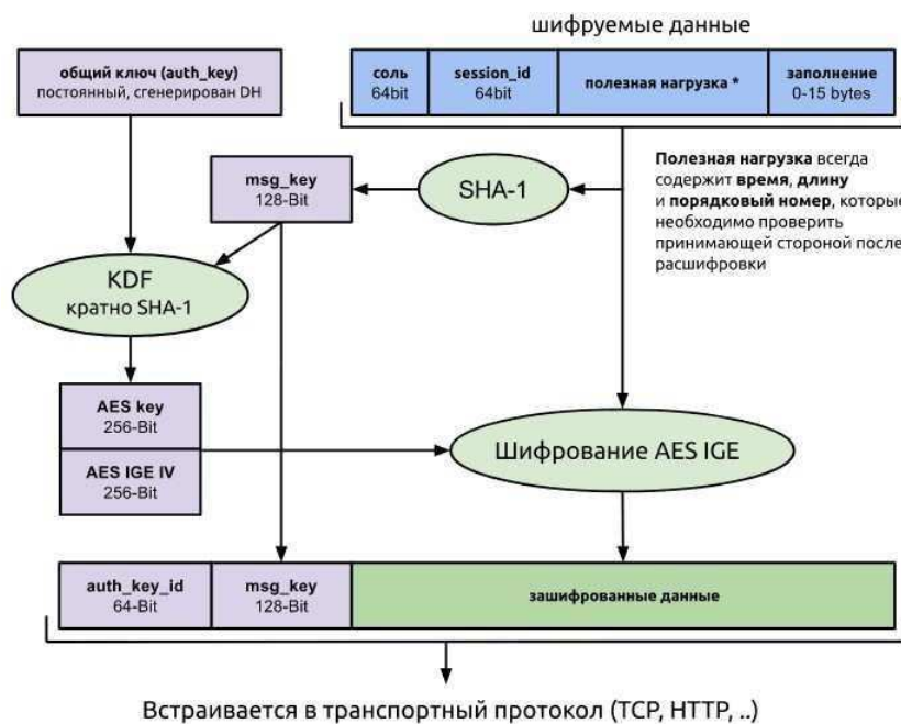
Рисунок 1 – Принцип работы протокола MTProto
