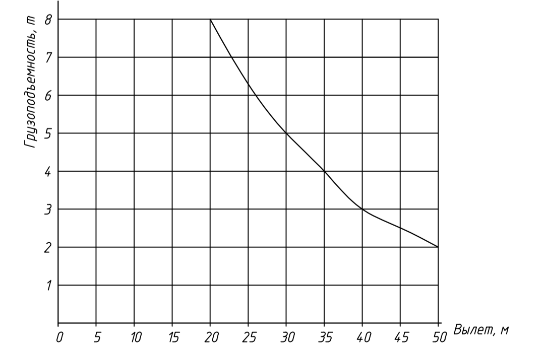
График зависимости грузоподъемности от вылета стрелы для крана КБ-473-04
