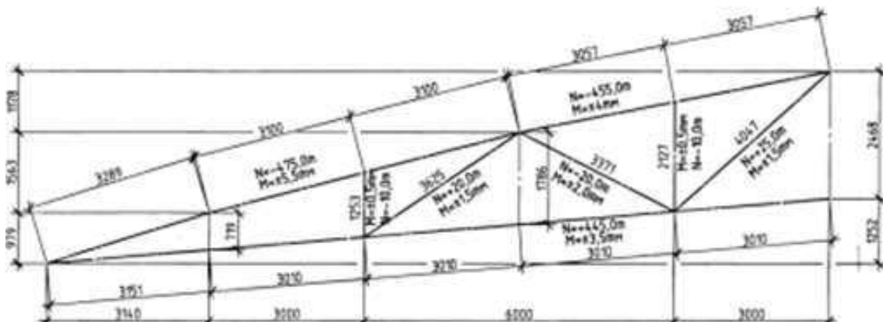
Рисунок 40 - Геометрическая схема отправочного элемента Ф1-1 фермы первого блока Ф1
