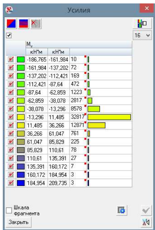
Рисунок 1.4 – Результат расчета каркаса, усилия M_y , кН*м
