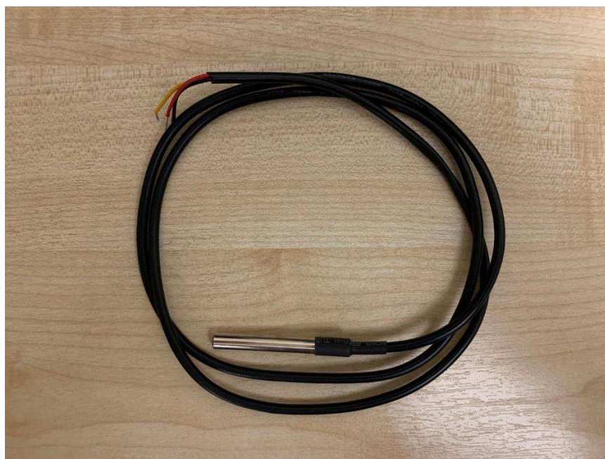
Рисунок 3.6 – Датчик температуры DS18B20
