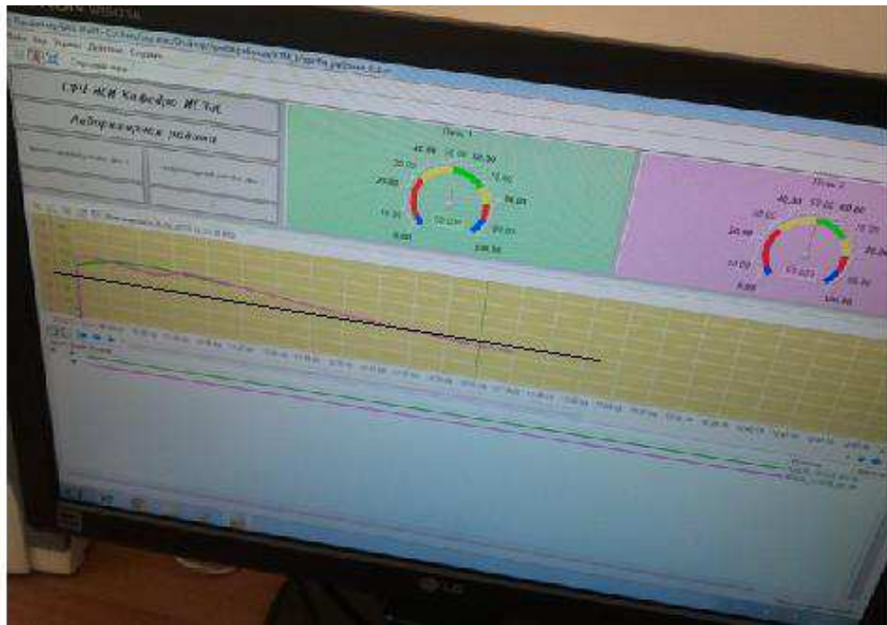
Рисунок 3.9 - Процесс охлаждения асфальтобетонной смеси, определенный измерителем-регулятором TRM151
