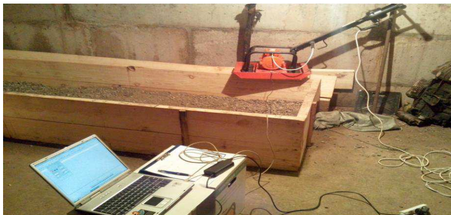
Рисунок 36 – Общий вид экспериментального оборудования и измерительного комплекса в лаборатории с грунтовым каналом
