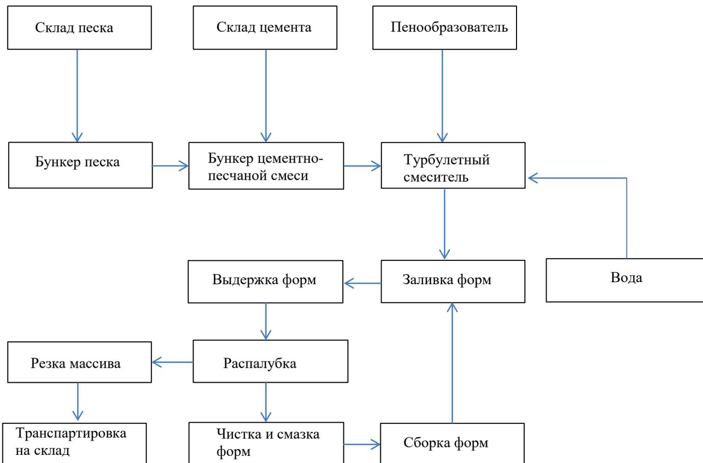
Рисунок 9 - функциональная схема производства пенобетона методом сухой минерализации.
