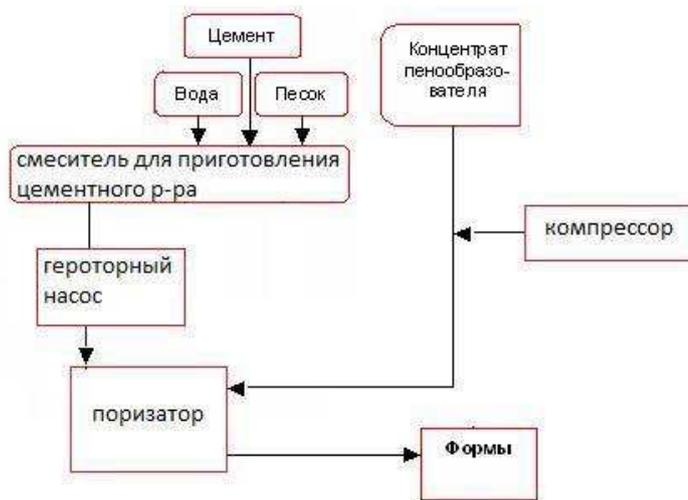
Рисунок 7 - Схема производства пенобетона способом «обжатие-релаксация» в непрерывном режиме.
