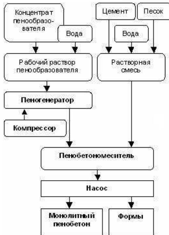
Рисунок 3 - Схема производства пенобетона классическим способом.
