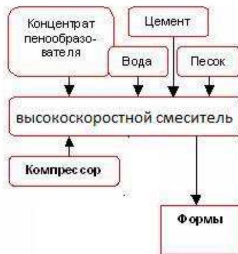
Рисунок 6 - Схема производства пенобетона турбулентно-кавитационным способом.
