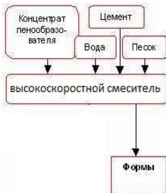
Рисунок 5 - Схема производства пенобетона способом аэрации
