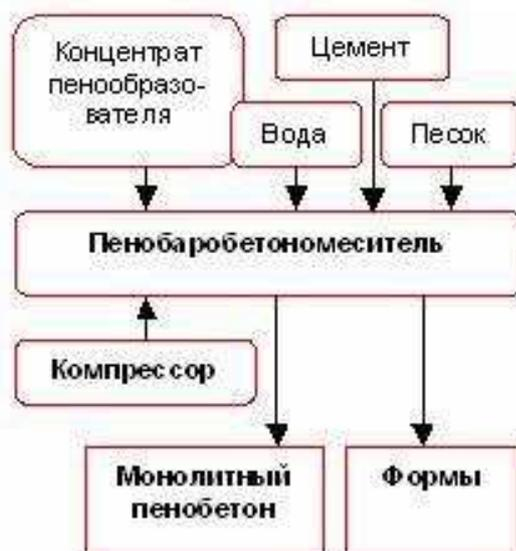
Рисунок 4 - Схема производства пенобетона способом баротехнологии
