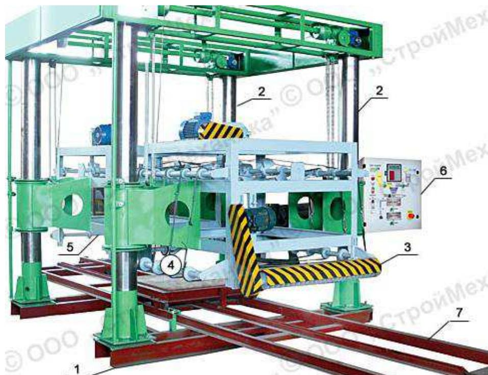
1-Монтажная рама-основание; 2- Направляющие кареток поперечной и продольной резки;
