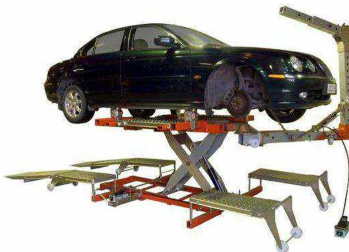
Рисунок 3.7 – Пример станда для восстановления геометрических размеров кузова или рамы - стапель Autorobot XLS++
