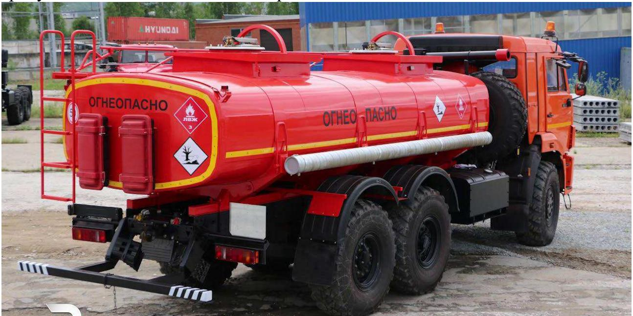
Рисунок 2.1 - Оформление автомобиля для перевозки легковоспламеняющихся жидкостей
