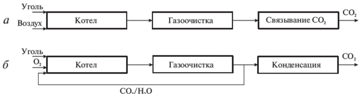
*a* — после сжигания твердого топлива в воздухе; *б* — после сжигания твердого топлива в кислороде.
