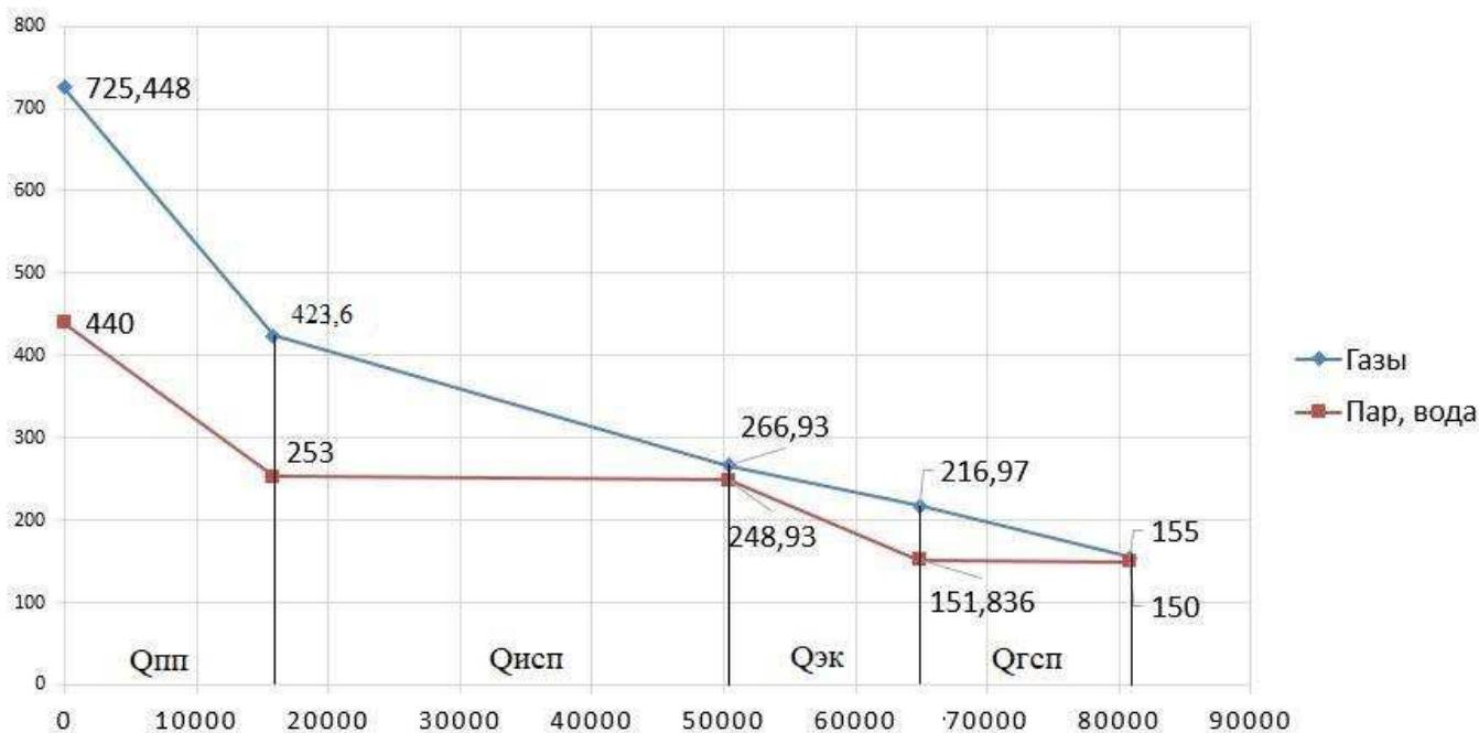
Рисунок 12 – Термовая диаграмма котла–utiлизатора
